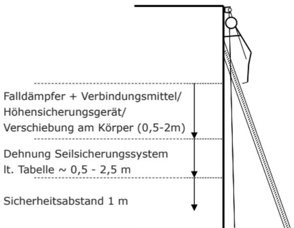
**Annahme:** Gesamtlänge Seilsicherungs-system 100 m und Stützenabstände 12 m
