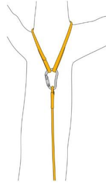
Fig. 5 - Ancoraggio della fune con dispositivo passante
